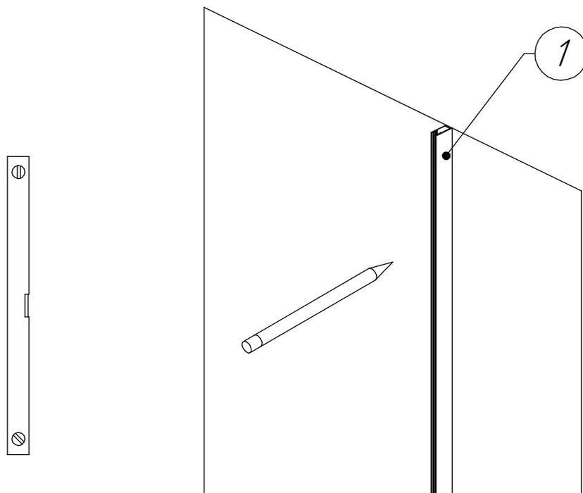
2. Вставьте стекло в профиль ближе к внешней стороне профиля. **Ни в коем случае не забивайте стекло по торцевой части, стекло подвержено при таких ударах к разрушению!** Вставьте с внутренней стороны профиля уплотнитель елочка (4). Прижмите уплотнитель равномерно по всей плоскости профиля.
